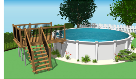
Exemple de plateforme dont l'accès est protégé par une enceinte.
